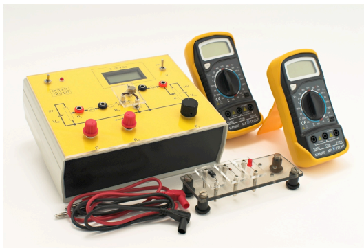
Slika 2. Nastavni komplet elektronika i izlazne karakteristike tranzistora
